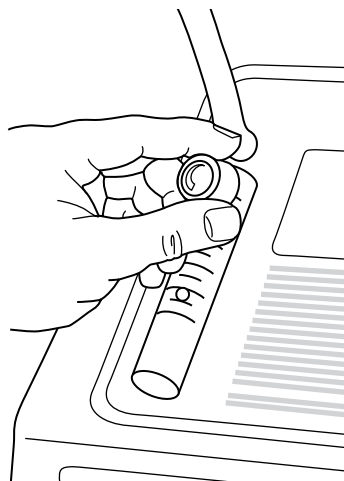
Use la perilla de selección de flujo para ajustar la velocidad de flujo de oxígeno (paso 5)
