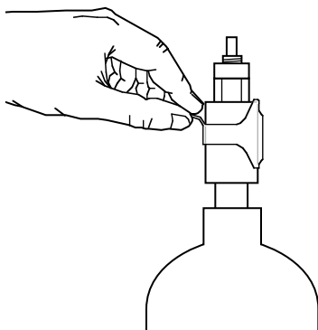
Quite el sello del tanque de la válvula del nuevo cilindro (paso 6)
